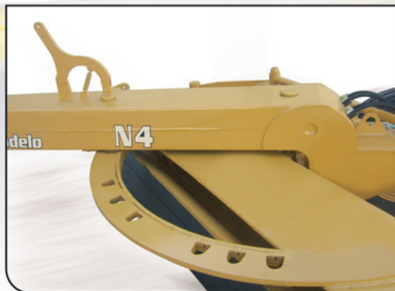
Rotación manual de vertedera con 9 posiciones de trabajo.
